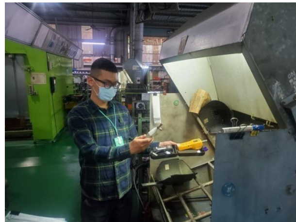
椅架現場燒焊照度檢測
