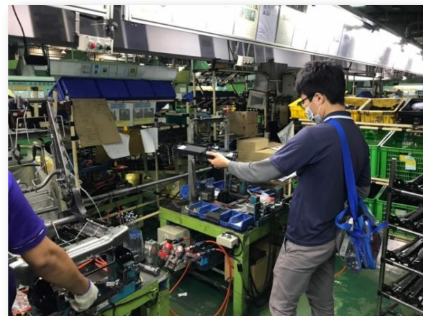
三廠椅架裝配-照度監測
