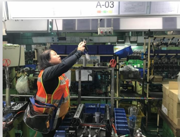
三廠椅架-劑量噪音監測
