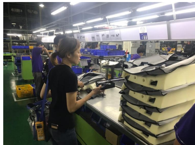
座椅產線照度(lux)檢測
